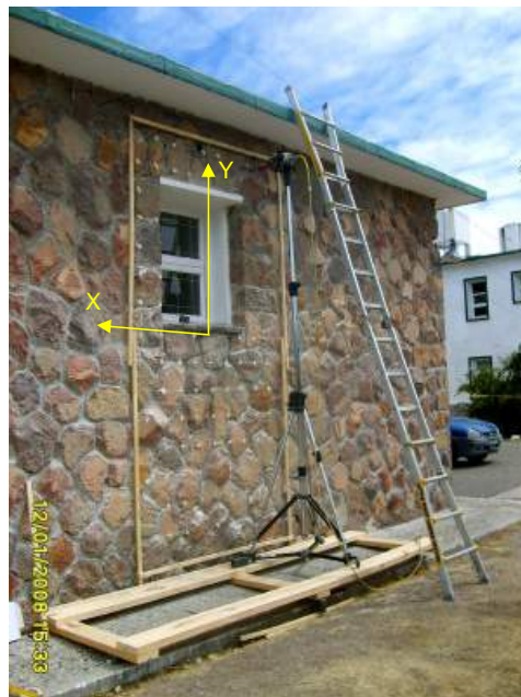
Foto 2. Bastidor y grilla en la pared exterior durante una medición en el sector superior. El riel de madera facilitó el desplazamiento del sistema fuente
